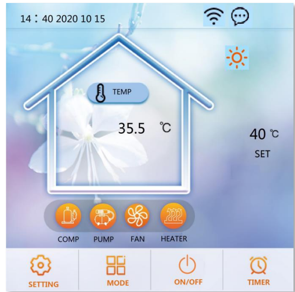
Status "Eingeschalten" (alle Schaltflächen in orange)
